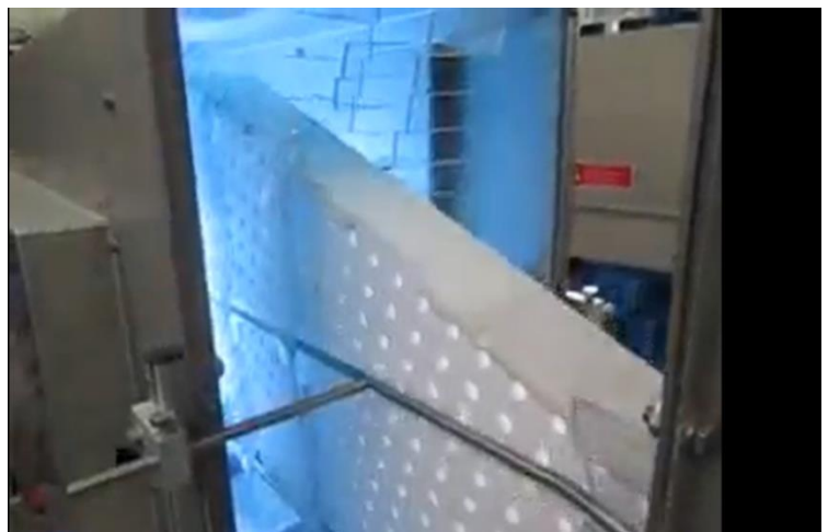
Esempio di trattamento UV-C superficiale di seminiere in polistirolo con dispositivi Light Progress.
