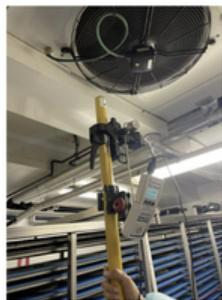
L'ispezione ha rilevato che i livelli di irraggiamento all'altezza degli occhi sono risultati 100 volte inferiori alla soglia di sicurezza di  $0,2 \mu\text{W}/\text{cm}^2$ , dimostrando un'esposizione eccezionalmente bassa nelle zone occupate.
