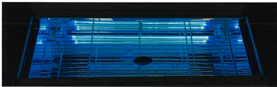
Figura 5. Box con sportello chiuso e luce UV-C accesa
