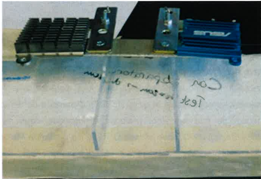
Figura 2 Sistema di lampada UV-C LED con il dissipatori di calore
