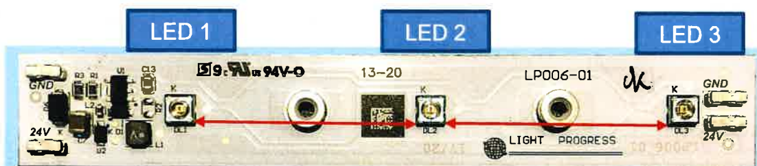
Figura 1 Sistema di lampada UV-C LED
