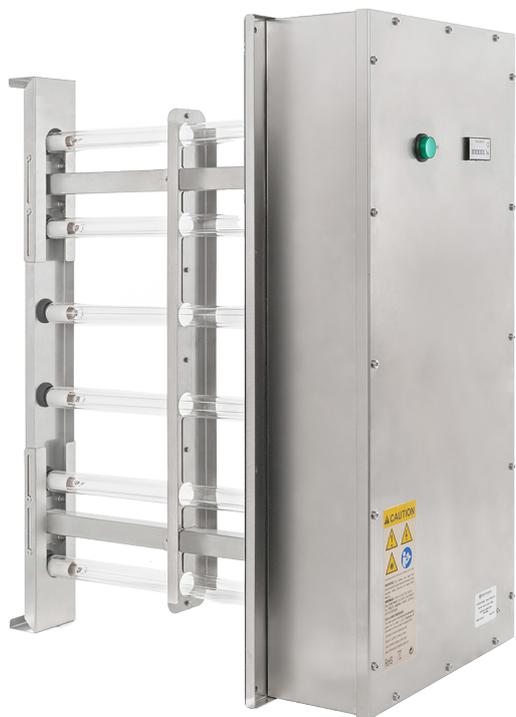
Die UV-RACK-Serie umfasst eine Reihe von Modulen aus Edelstahl AISI 304 in verschiedenen Größen und Leistungen. Die UV-C-Lampen sind gleichmäßig voneinander entfernt und so positioniert, dass ein Netz entsteht, durch das die Luft nach dem Einbau des Geräts in die Hauptleitungen geleitet wird.
