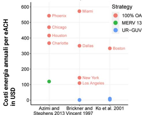
Rispetto alla ventilazione meccanica o ad altri dispositivi di purificazione dell'aria, la tecnologia Upper-Air è **molto meno costosa e permette di garantire un numero equivalente di cambi d'aria all'ora (ACH) in un anno\***.
